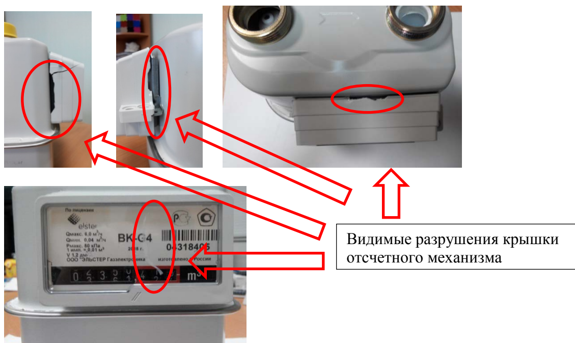
Рисунок 2 – Разрушения крышки отсчетного механизма, обладающей свойством фиксации внешних механических вмешательств, при попытке ее демонтажа
