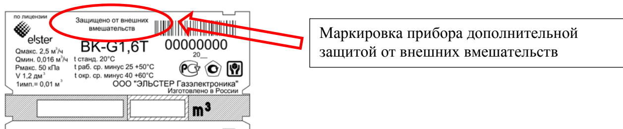
Рисунок 1 – Главный шильдик счетчика газа ВК –G1,6Т с дополнительной защитой от внешних вмешательств
